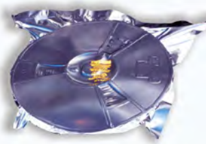
Busta barriera sigillata con una eccessiva evacuazione d'aria.
